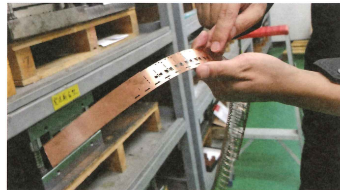
順送金型による金属のプレス加工をサンプルでご説明いただきました
