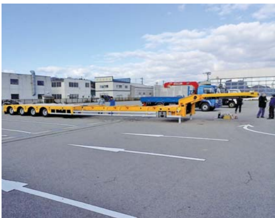
コメット社製（イタリア）の荷台が伸びるトレーラー
