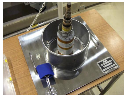
超電導直流送電管の内部(出典:WirelessWire News)
