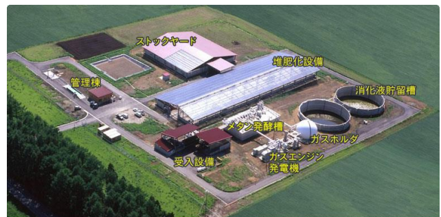
バイオマスパワーしずくいの全容(出典:株)バイオマスパワーしずくいし)
