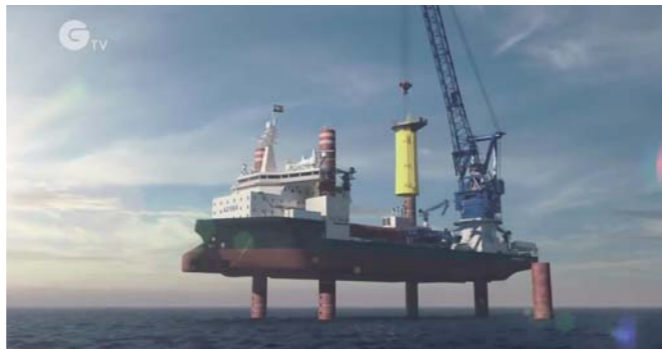
(ジャッキアップされたSEP船(シーメンス社動画より))
