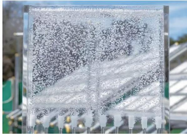
左/光触媒パネル、右/発生した水素と酸素の混合気体 (画像: NEDO)
